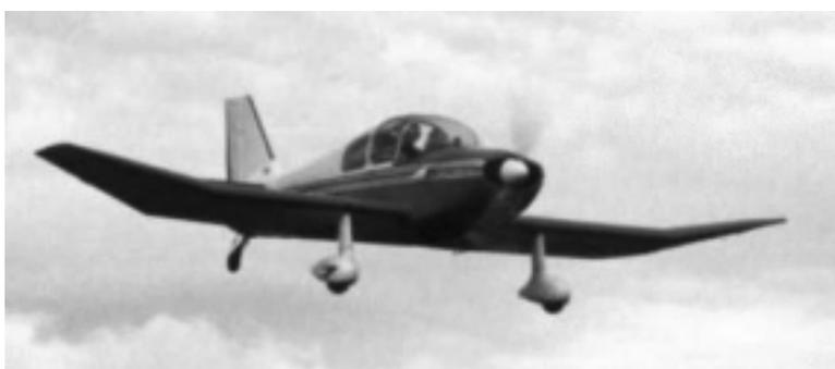
Le carenature delle ruote sono di materiale stampato in vetroresina.
